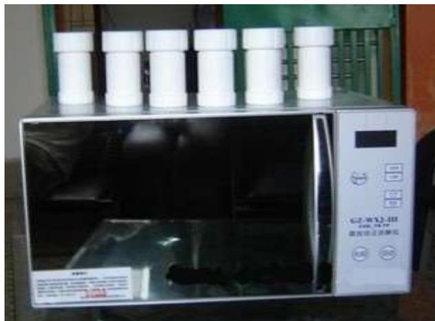
图 2-10 微波闭式消解仪的实物图
